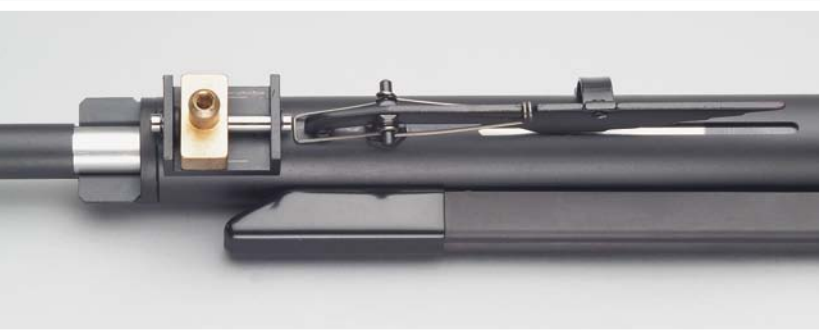
Ausgeschäftet. Die Spannhebelsicherung wird mit einer speziell gebogenen Drahtfeder durch eine Längsnut gegen den Luftzylinder gedrückt.
