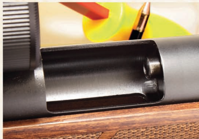
Mit dem ZF 4-16 x 42 bleibt die 470er Lademulde zugänglich, zum Schließen muss ein Knopf als Sicherung eingepresst werden.
