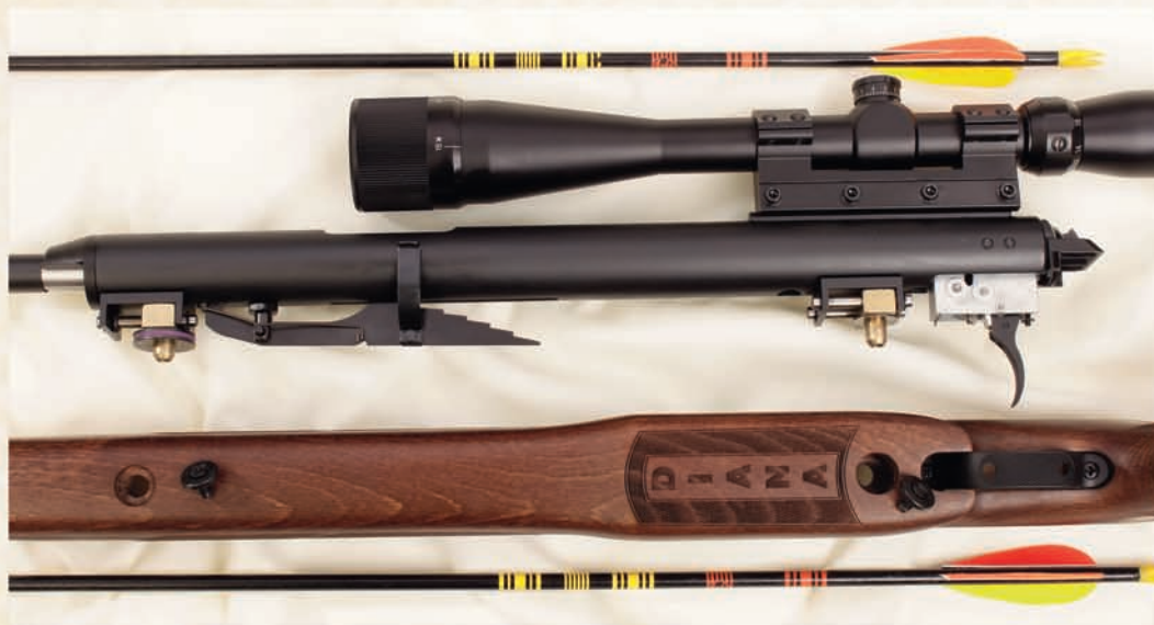
Das 56er System ruht wie beim 54 Airing auf waagerechten Schienen (in den Messingblöcken, eine vorn und zwei hinten). Im Schuss leiten sie die Rücklaufenergie über Kugeln nach unten ab.
