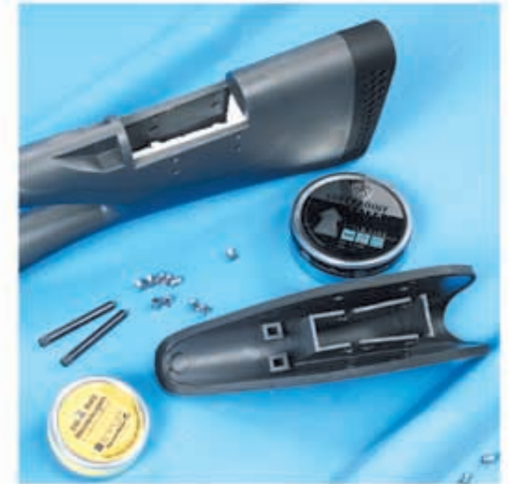
Der hohle Genesis-Hinterschaft wurde schalldämmend mit Styropor gefüllt. Die Gummibacke kann durch zwei Querstifte in zwei Positionen fixiert werden (etwa für die ZF-Montage).
