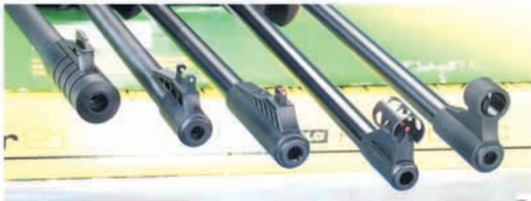
Alle Laufmündungen werden durch überstehende Kunststoffwülste verdeckt und geschützt. Von links: Gamo Trooper mit wechselbarem Korn, Remington Genesis und Diana Panther 21 mit lightsammelnden Fiberglas-Einsätzen, dann die Korntunnel des Norica Krono und des Perfecta 55.
