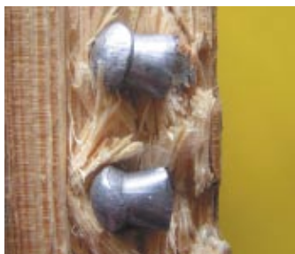
HW 90: Eindringtiefe in trockenes Fichtenholz beträgt 14 mm.
