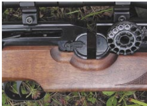
HW 100: Vor dem Einsetzen des „Trommel“-magazins in den Magazin-„schacht“.
