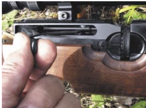
HW 100: Das „Magazin“ mit 14 Diabolos ist eingesetzt, das Gewehr wird gespannt.
