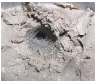
HW 90: 35 mm Eindringtiefe in Kitt bei Beschuss aus 35 m mit RWS.
