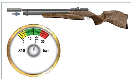
3. Contrôlez l'affichage du manomètre de la carabine et de l'équipement de remplissage. Nous conseillons de remplir la cartouche à une pression de 250 bar. Veillez à ne jamais dépasser une pression de remplissage de 250 bar !
