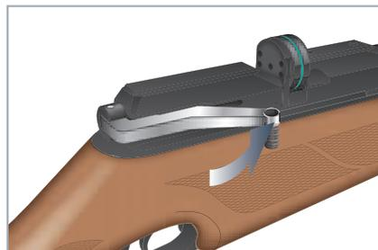
4. Schließen Sie den Spannhebel.
