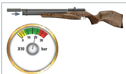
3. Compruebe el manómetro de la carabina de aire y del equipo de llenado. Recomendamos llenar el cartucho con una presión de 250 bar. **¡Asegúrese de nunca sobrepasar los 250 bar!**
