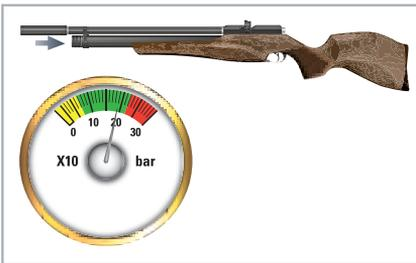
3. Beobachten Sie das Manometer Ihres Gewehrs. Wir empfehlen die Kartusche mit 250 bar zu befüllen. **Füllen Sie niemals mehr als 250 bar in die Kartusche!**
