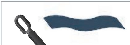
**1.** Enclenchez la sûreté (« Safety ON »). Attachez un chiffon de coton à l'extrémité d'une tige de nettoyage.
