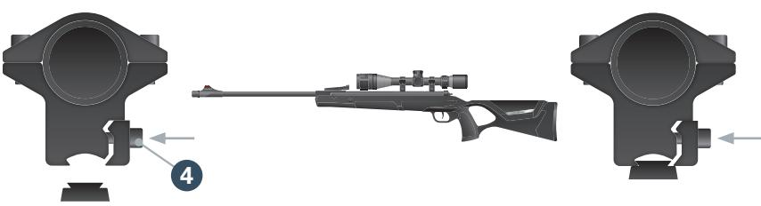
4. Desserrez la vis de fixation **4** de chacun des deux montages et placez la lunette de visée (avec les montages installés comme décrit) sur le rail en queue d'aronde de l'arme, puis fixez l'assemblage en place au moyen des vis de fixation.
