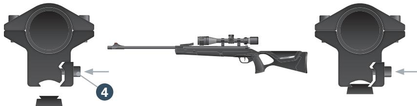
4. Lösen Sie die Fixierschraube **4** und setzen Sie das Zielfernrohr mit der Montage auf die Prismenschiene der Waffe und klemmen Sie es mit der Fixierschraube fest.
