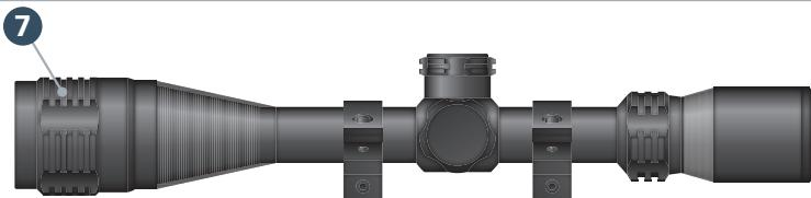
1. Stellen Sie die Fokussierung mit der Einstellung **7** des Objektiv ein, bis Sie ein scharfes Bild erhalten.
