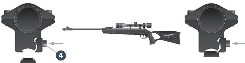
4. Afloje el tornillo de fijación **4** de cada uno de los dos montajes y coloque la mira telescópica (con los montajes instalados tal como descrito) sobre el raíl de cola de milano del arma, entonces fije el conjunto mediante los tornillos de fijación.
